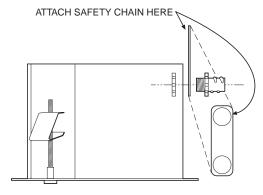
Figure 5. Conduit Fitting Installation
